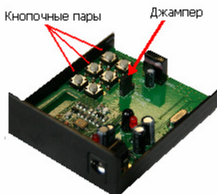
Рисунок 2. Плата ИК-контроллера с кнопочными парами и джампером
